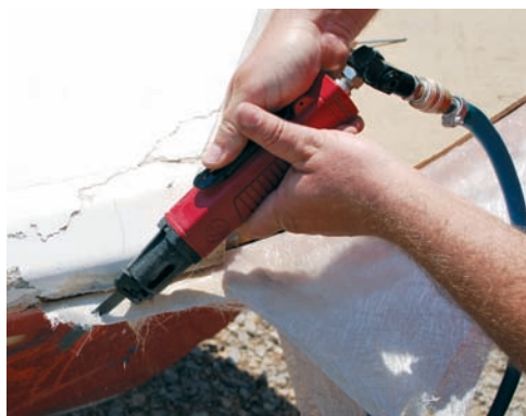
Malena zračna pila je idealna za rad u stakloplastici i općenito oko plovila
