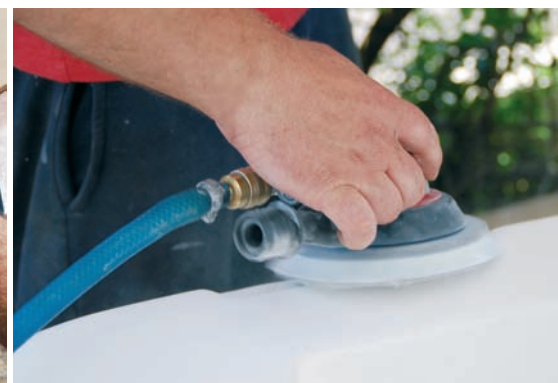
Uz pomoć rotacijsko-oscilacijske brusilice podloga se može obraditi vrlo brzo
