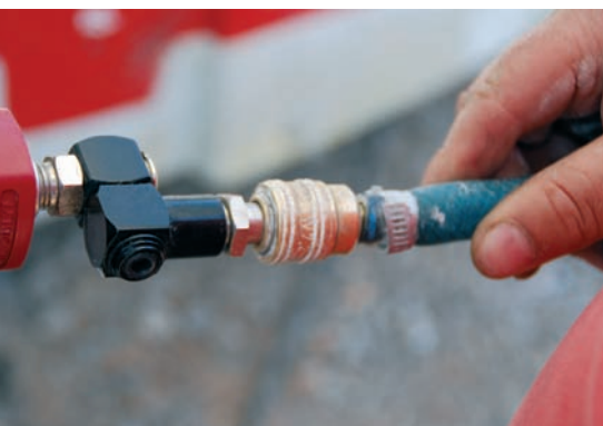
Pneumatski alati moraju se spojiti na kompresor
