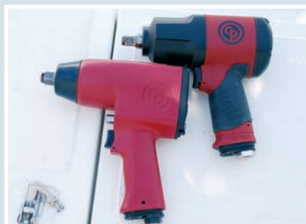
Zračni pištolj CP 7620 1/2 cola. Brzina vrtnje: 8.400 o/min. Radni zakretni moment: od 34 do 420 Nm (reverzno 576 Nm). Masa: 2,33 kg. Cijena: 1.512,00 kn + PDV
