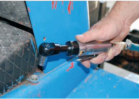
Pneumatski kriket (račna) uz pomoć seta udarnih ključeva u par sekundi obavi ono za što bi inače trebalo nekoliko minuta
